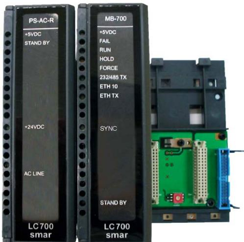
شکل ۱۷ - ۷: نمای کارت MB-700 که با یک منبع تغذیه روی یک rack نصب شده اند.
